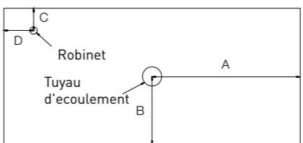
Indiquer les dimensions et le diamètre du tuyau d'écoulement et du robinet en milimètres.
