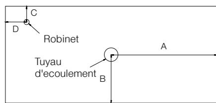
Indiquer les dimensions et le diamètre du tuyau d'écoulement et du robinet en millimètres.
